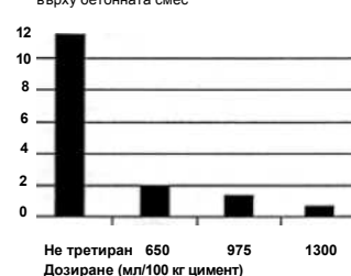
Влияние на дозировката на RHEOMAC UW450 върху бетонната смес
